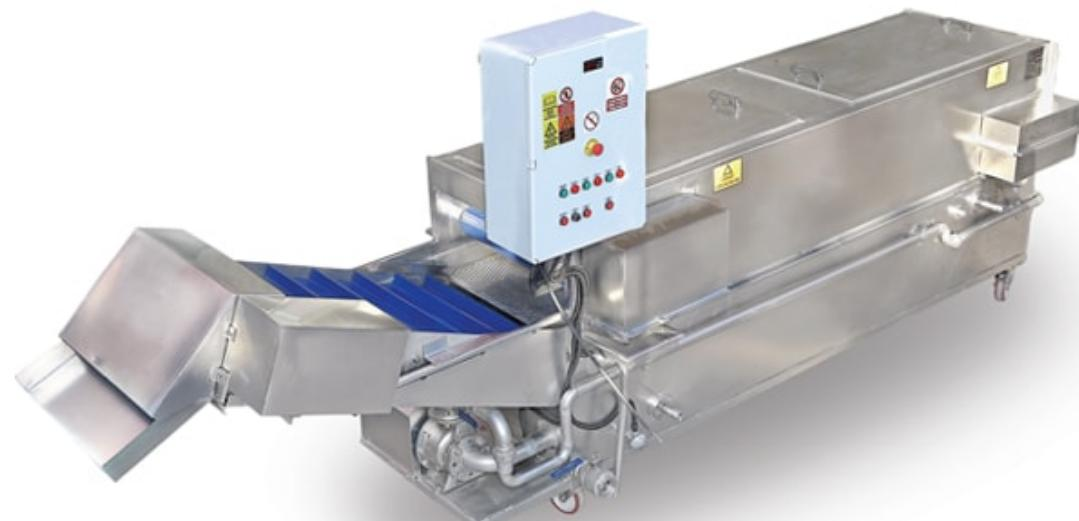
Meyve ve sebzelerin istenilen süre ve sıcaklıkta haşlama yapma makinesidir. Kabuk soyma hattında ürünlerin kabuklarının daha kolay soylanması için ıslı işlem yapmak amacıyla kullanılmaktadır.
